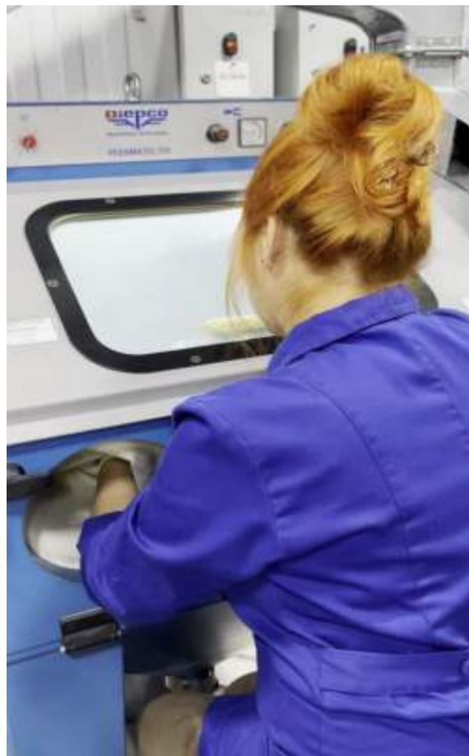
Одна операция обработки инструмента на роботизированном абразивном аппарате заменяет две ручные операции: очистку инструмента от заусенцев и загрязнений и скругление режущей кромки на галтовке.
